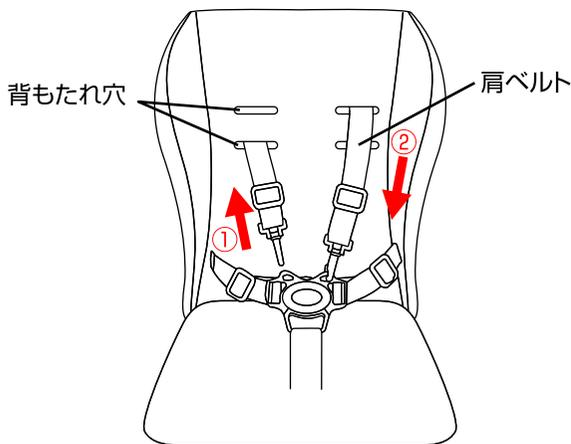
・①肩ベルトの高さを調節する場合は、肩ベルトを背もたれの穴に差し込み、②適切な高さの肩ベルト穴から出してください。
