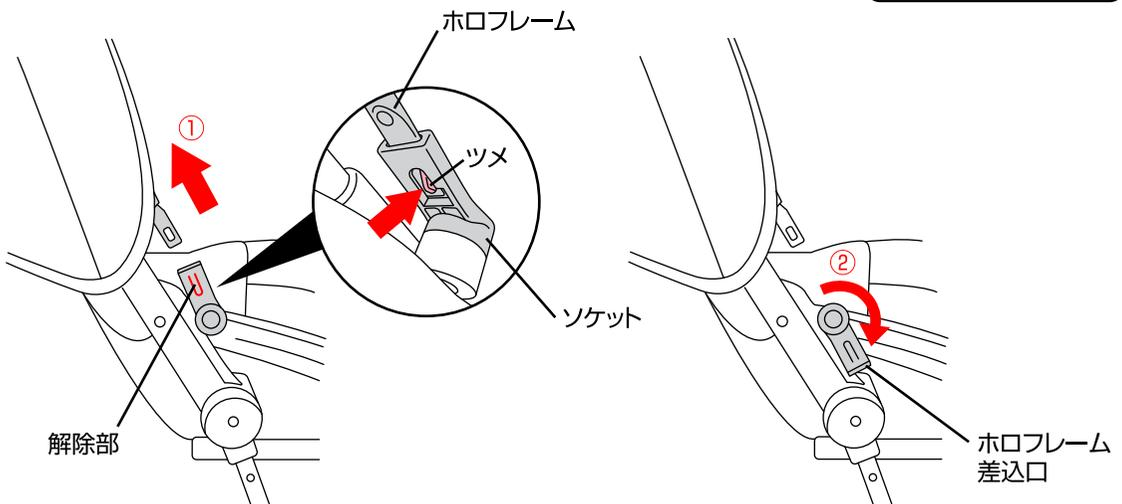
・①ソケットの解除部内側のツメを押してホロフレームを取り外し、
