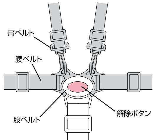
・シートベルトを取り付ける場合は、肩ベルトを腰ベルトに取り付け、股ベルトに差し込んでください。
