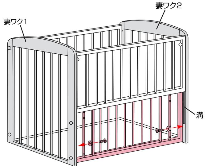
・妻ワク1と2の溝の下のネジ穴にスライド止めワッシャーをスライド止めボルトで固定してください。
