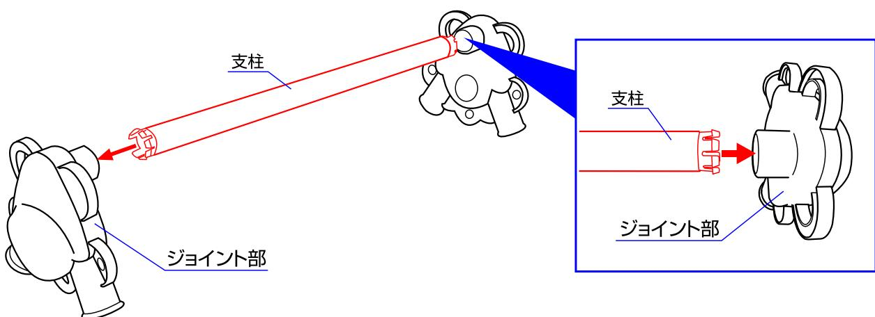
1. 支柱をジョイント部の穴に差し込んで下さい。 ※支柱を奥まで確実に差し込んで下さい。
