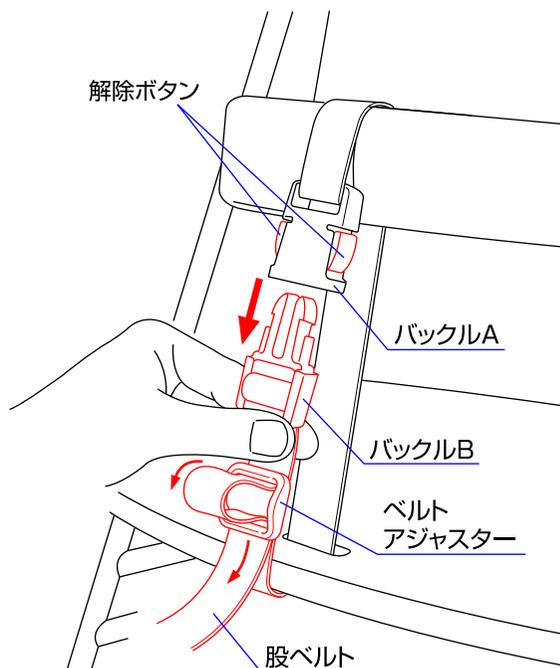
10. 股ベルトの先端を引っ張り、確実に締め付けて下さい。 11. バックルAの両側の解除ボタンを押して、一旦バックルBを外して下さい。緩まないように指でバックルBを押さえながら、股ベルトをベルトアジャスターに通して下さい。
