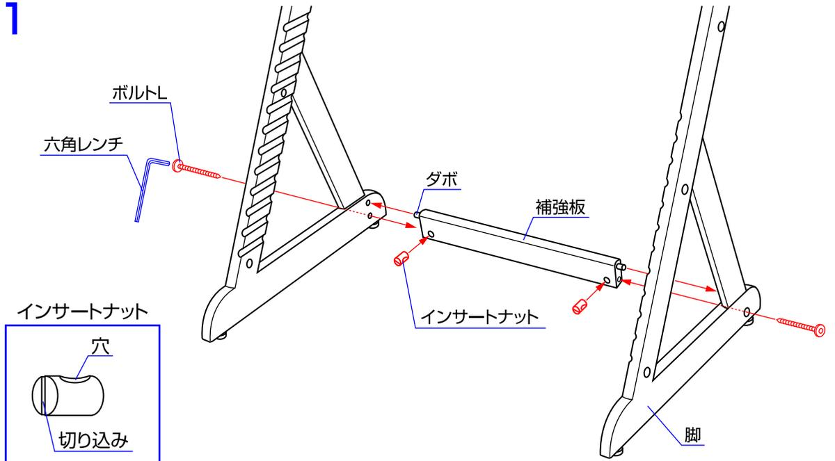
1. 補強板にインサートナットを差し込み、両側の脚にダボとボルトLで軽く締めて下さい。
