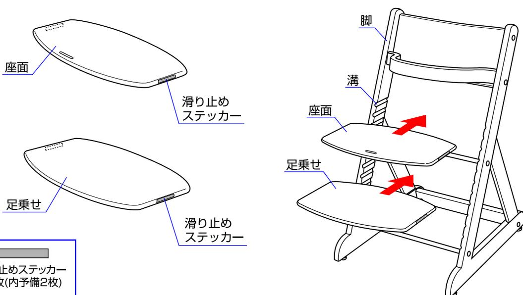
◇座面と足乗せの左右両側に滑り止めステッカーを貼ってから脚の溝に差し込んで下さい。
