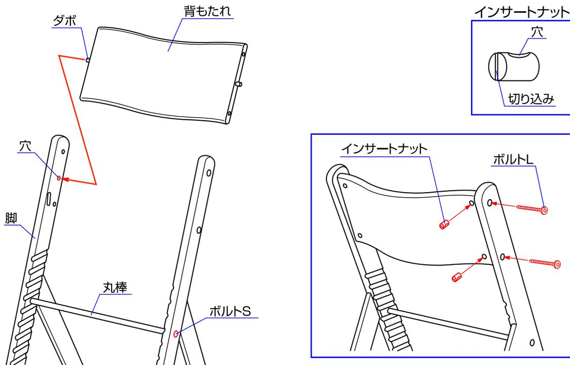
3.背もたれのダボを脚の穴に差し込んで下さい。背もたれの裏側からインサートナットを差し込み、ボルトLで軽く締めて下さい。インサートナットは切り込みを手前にして穴をボルト方向へ向けて差し込んで下さい。
