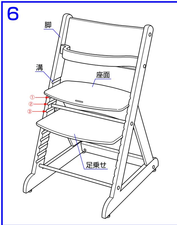
6.座面、足乗せの間の脚の溝は必ず3つ以上空けるようにして下さい。
