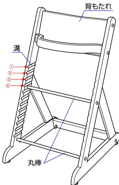
5. 座面と足乗せをお子様の身体に合わせて脚の溝に差し込み、丸棒2本の両側のボルトSと背もたれのボルトLを最後まで確実に締め付けて下さい。※使用する前に必ず座面と足乗せを前後に引っ張り、抜けないことを確認して下さい。
