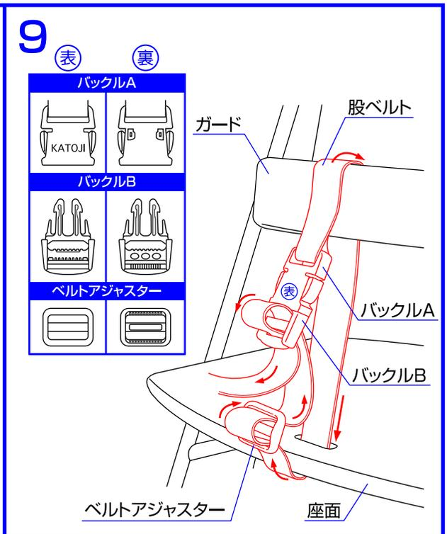
9.股ベルトをガードの上から回して座面に通し、ベルトアジャスターに通してから、バックルBに通して下さい。
