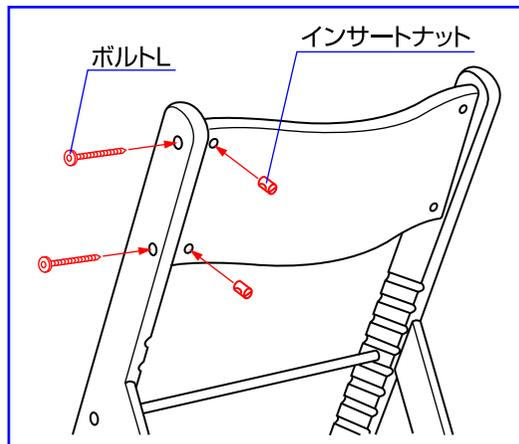
4. ガードを脚のガード穴に差し込んで下さい。反対側の脚にもガードと背もたれのダボを差し込み、背もたれの裏側からインサートナットを差し込み、ボルトLで軽く締めて下さい。
