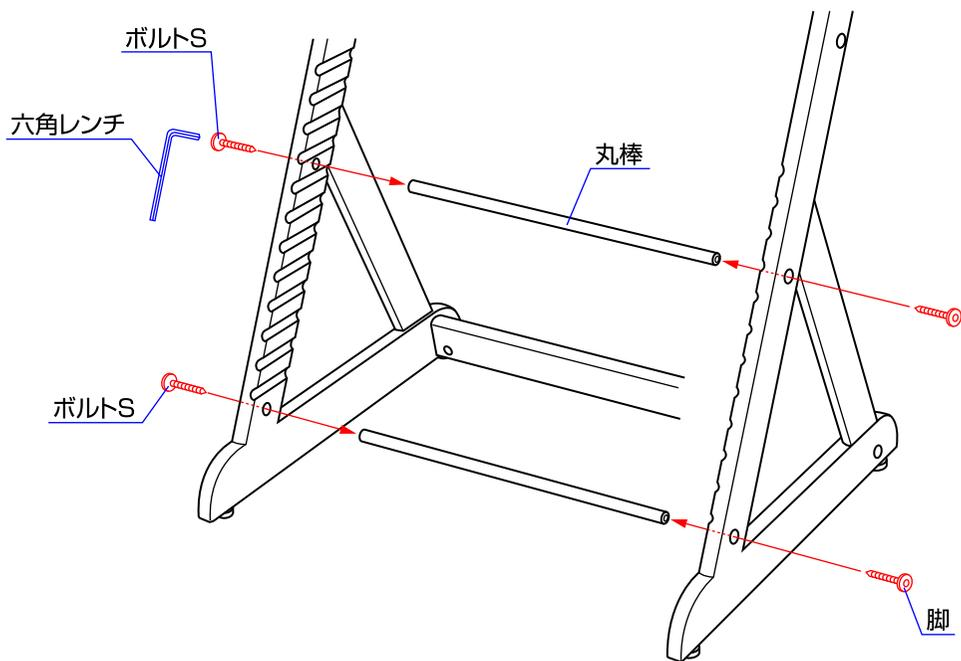
2.丸棒2本を両側の脚にボルトSで軽く締めて下さい。
