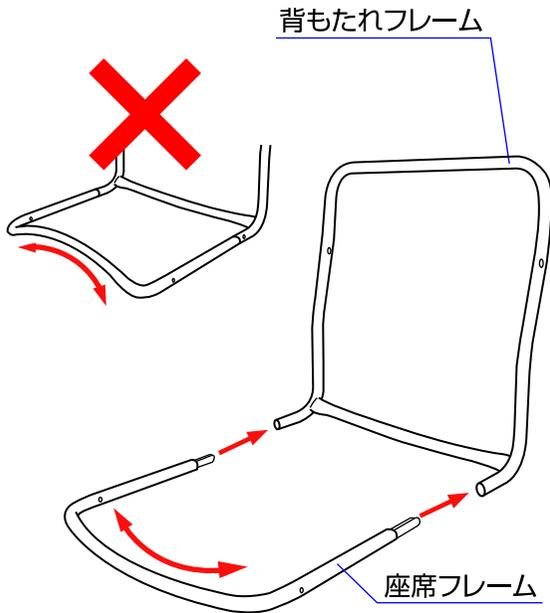
1. 背もたれフレームと座席フレームを組み合わせて下さい。座席フレームの向きに注意して下さい。
