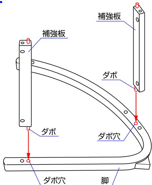
4. 補強板のダボを脚のダボ穴に入れて下さい。反対側の脚も同じように取り付けて下さい。
