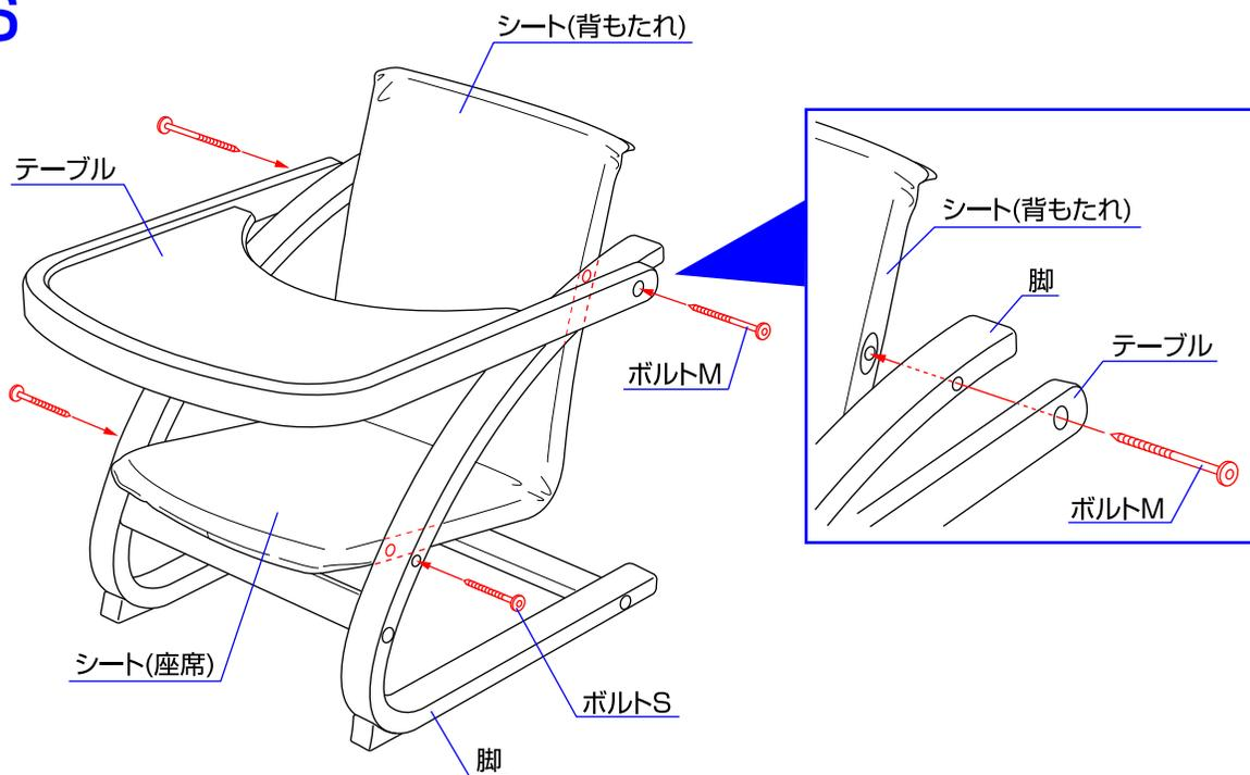
6.脚にシートとテーブルを取り付けて下さい。脚の両側からシートの座席にボルトSで締めて下さい。テーブルの両側からボルトMを脚に通して、シートの背もたれに締めて下さい。
