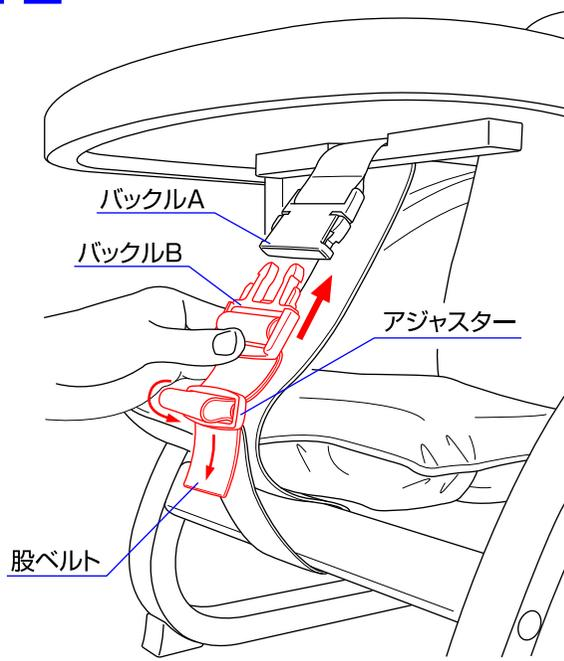
12. 緩まないようにバックルBを指で押さえながら、股ベルトをアジャスターに通し、バックルBをバックルAに差し込んで下さい。
