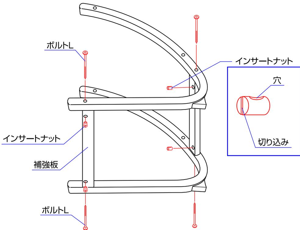
5.補強板にインサートナットを入れてボルトLで締めて下さい。※インサートナットは切り込み部分を手前にして、穴をボルト方向へ向けて下さい。
