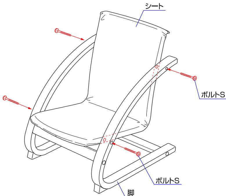
◇脚の両側からシートをボルトSで締めて取り付けて下さい。
