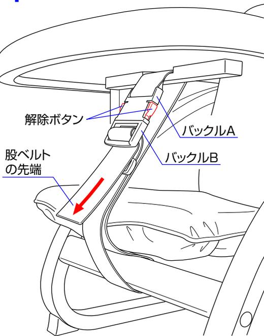
11. 股ベルトの先端を引っ張り、確実に締め付けて下さい。
