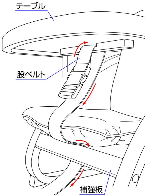
9.股ベルトをテーブルの裏側に通し、補強板を巻くように通して下さい。
