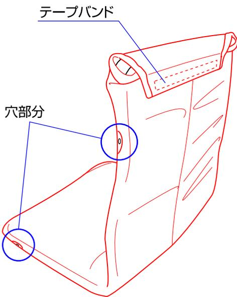
3. シートカバーをテープバンド(図の部分の裏地に付いています)で固定して下さい。シートカバーの穴とフレームの穴を合わせて下さい。
