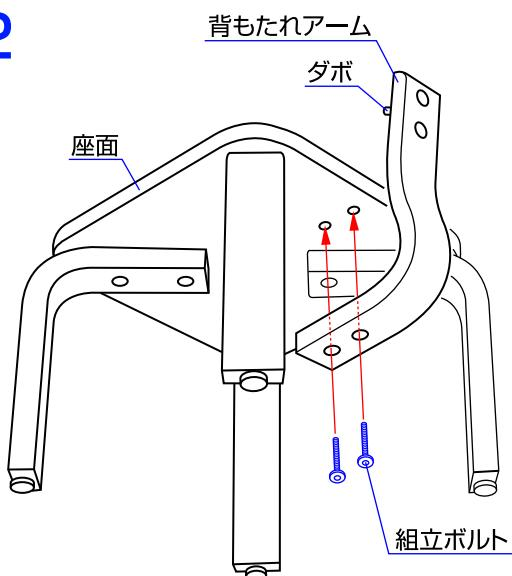
2. 背もたれアームのダボがある方を上にして、座面に組立ボルトで取り付けて下さい。
