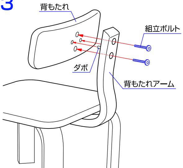
3. 背もたれアームのダボを背もたれに差し込み、組立ボルトで取り付けて下さい。※全てのボルトが確実に締め付けられていることを必ず確認してからご使用下さい。
