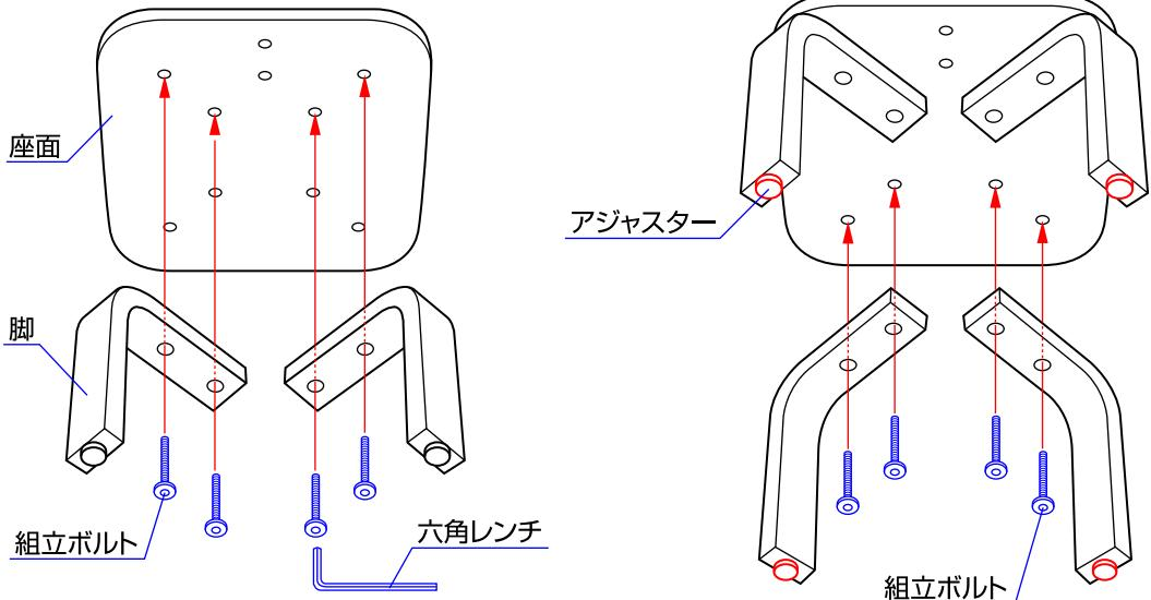
1. 座面に脚(計4個)を組立ボルトで取り付けて下さい。組立ボルトは六角レンチで確実に締め付けて下さい。※製品の性質上、がたつく場合がありますので、その場合には脚の裏側に付いているアジャスターを回して調節して下さい。
