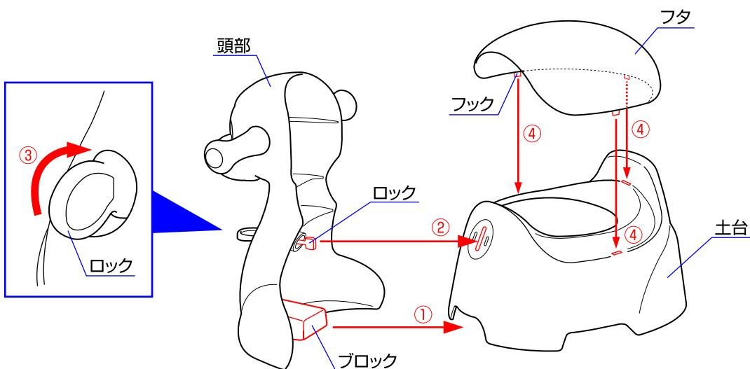
1.①おまるの頭部のブロックを土台の下に差し込み、②頭部のロックを土台の穴に差し込んで下さい。③ロックを回して頭部を固定して下さい。④フタのフック(3カ所)を土台の穴に合わせてかぶせて下さい。
