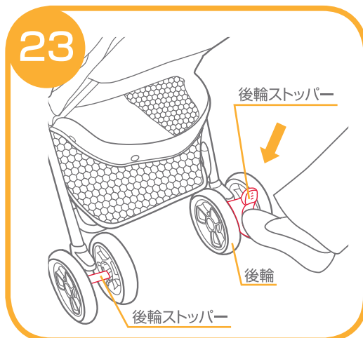
23.両側の後輪に付いている後輪のストッパーを下げると後輪がロックされます。※後輪ストッパーは自動車のような安全な構造にはなっていませんので過信しないで下さい。
