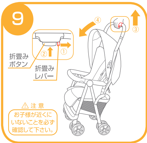
9. 本体を折畳む場合は、①折り込みレバーを開き、②折り込みボタンを握って下さい。③ハンドルを持ち上げて、④本体を前に倒しながら折畳んで下さい。
