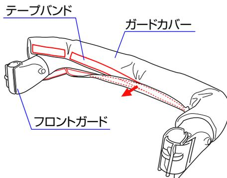
◇ガードカバーのテープバンドを外して、フロントガードから取り外して下さい。
