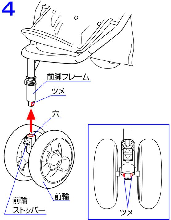
4.前脚フレームに前輪を差し込んで下さい。※前輪ストッパー側の穴が上になるようにして差し込んで下さい。※前輪フレーム先端のツメが出ていることを必ず確認して下さい。
