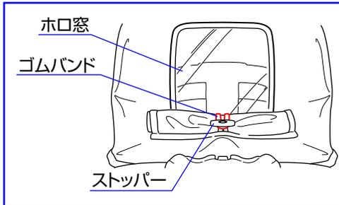
◇ホロの窓カバーを開けて、窓カバーを巻いて下さい。窓カバーの裏側にあるゴムバンドで窓カバーを束ねてストッパーに掛けて下さい。
