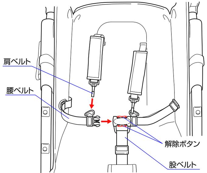
◇取り付けの際は肩ベルトを腰ベルトに取り付け、股ベルトに差し込んで下さい。腰ベルトを取り外す時は解除ボタンを押して、股ベルトから取り外して下さい。
