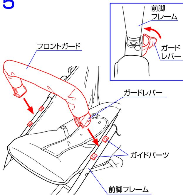
5.フロントガードを両側の前脚フレームに付いているガイドパーツの間に取り付け、ガードレバーで固定して下さい。※確実に固定されていることを必ず確認して下さい。
