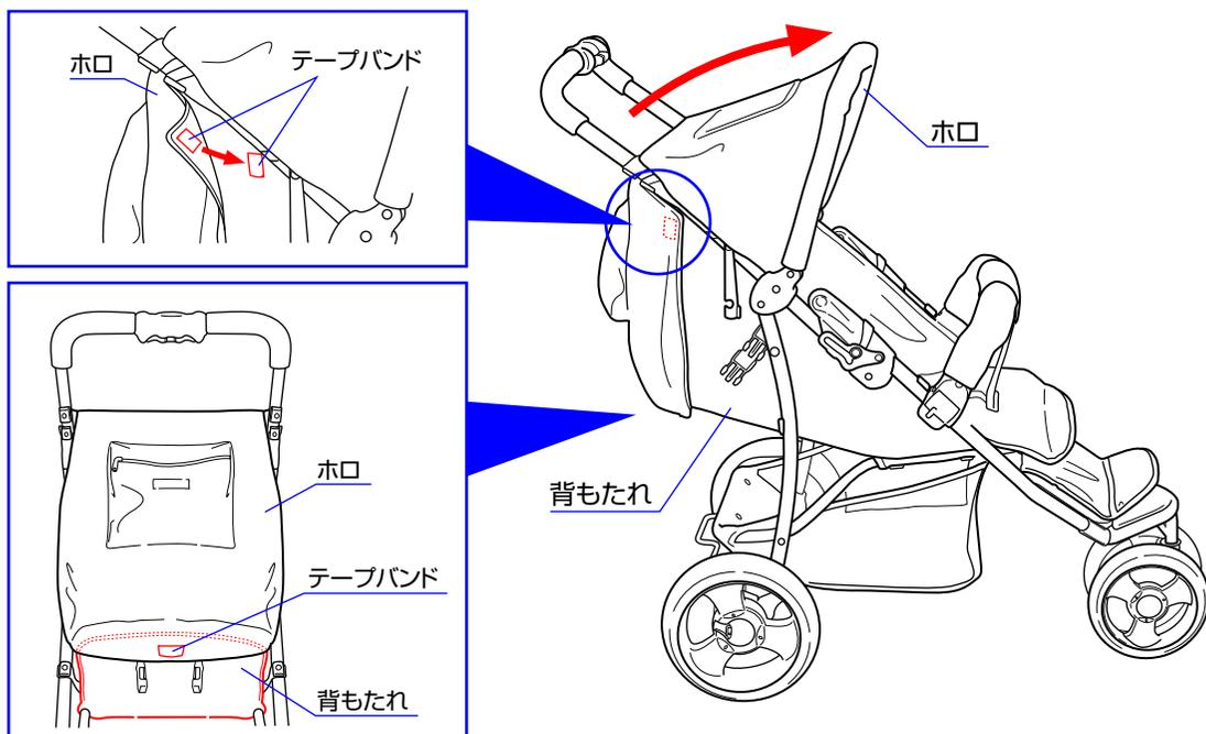
7.ホロの左右両側のテープバンドと後部のテープバンドを背もたれのテープバンドに取り付けて下さい。(計3箇所)ホロを図のように開いて下さい。
