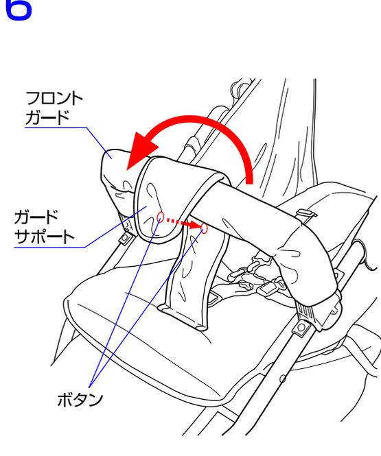
6.ガードサポートを図のようにフロントガードに巻き付け、ボタンで固定して下さい。
