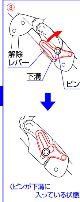
2. ①ハンドル中央の解除ボタンを押しながら、②ハンドルロックを解除レバーが少し動くまで矢印方向に回して下さい。解除レバーが動いたことを確認したら、ハンドルロックを回すのを止め、そのままの状態③解除レバーを矢印方向に上げて、ピンを下溝に入れて下さい。※ピンが下溝に入っていることを必ず確認して下さい。
