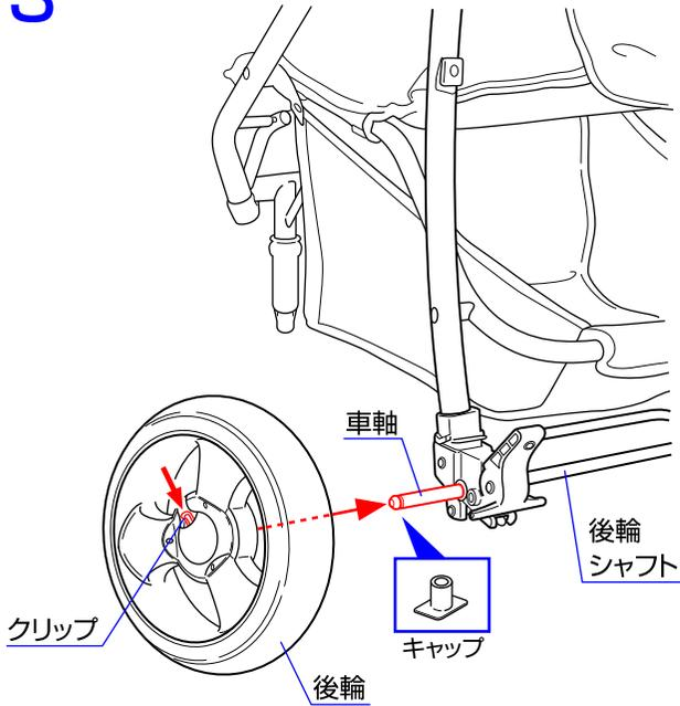
3.後輪シャフトの両側の車軸からキャップを取り外して下さい。後輪のクリップを押しながら、両側の車軸に差し込んで下さい。※キャップは使用しませんので廃棄して下さい。※両側の後輪が車軸から抜けないことを必ず確認して下さい。
