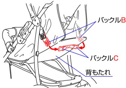
◇背もたれの裏側に付いているバックルで高さを調節して下さい。(3段階調節)
