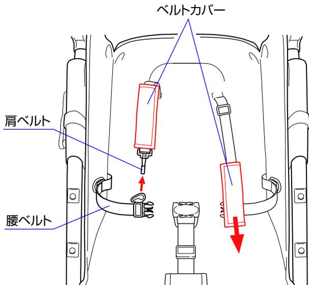
◇肩ベルトを腰ベルトから外し、ベルトカバーを抜いて下さい。
