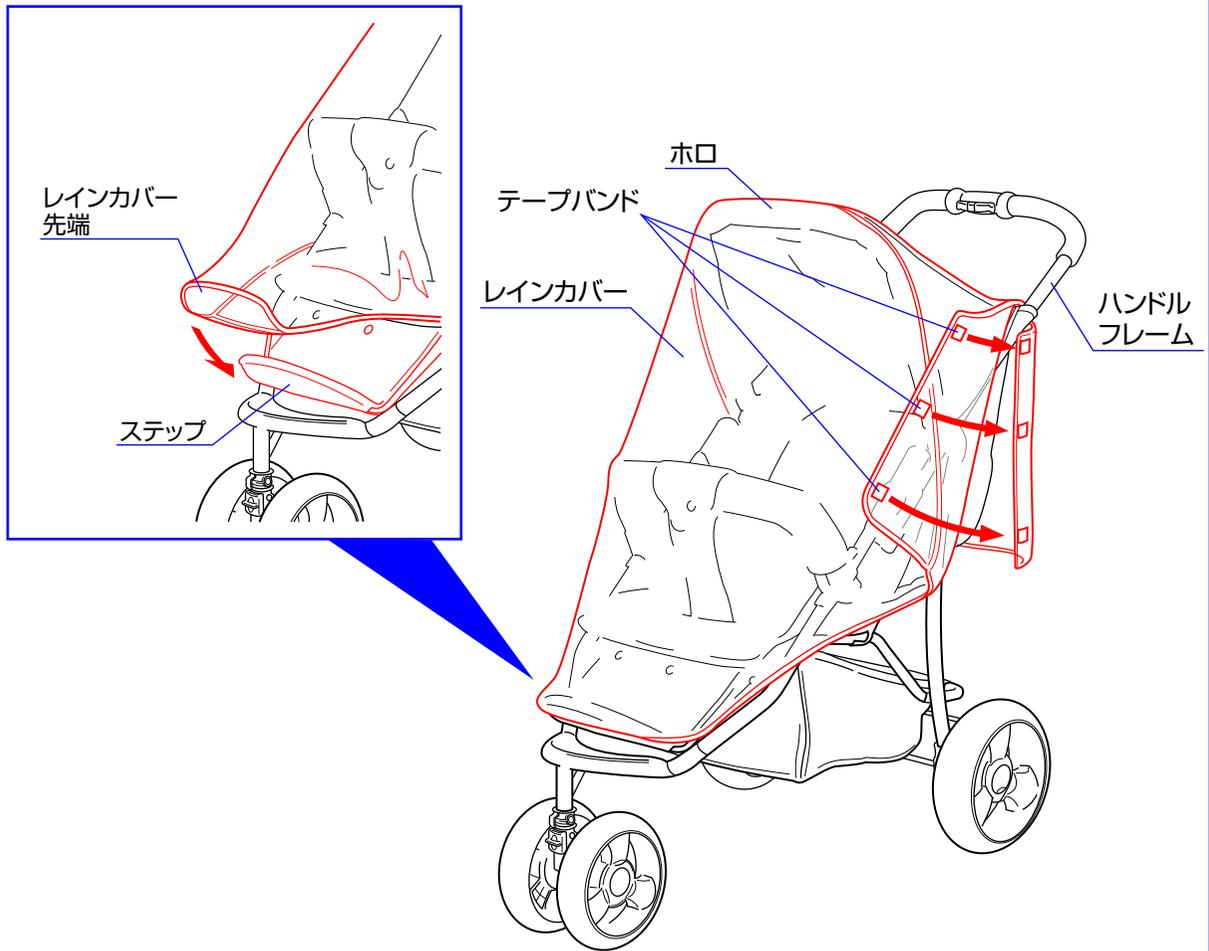
◇レインカバーを図のようにホロにかぶせ、ハンドルフレームを挟むようにして両側のテープバンドを付けて下さい。
