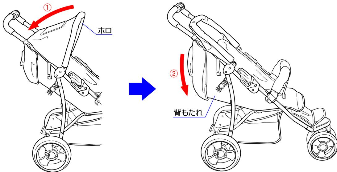
1.①最初にホロを折畳み、②背もたれを下段にして下さい。(P5「背もたれの高さ調節」を参照して下さい。)
