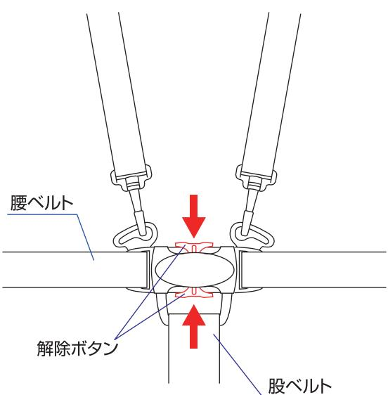
◇肩ベルトを腰ベルトに取り付け、股ベルトに差し込んで下さい。
