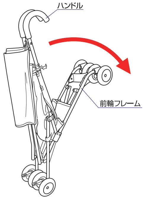
1. 前輪フレームに取り付けられている開閉ロックを外して下さい。
