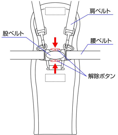
◇腰ベルトを取り外す時は、股ベルトの解除ボタンを押して取り外して下さい。※ベビーカーの使用中は必ずシートベルトを締めて下さい。
