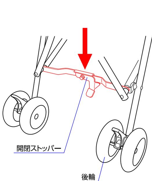
3.後輪側に付いている開閉ストッパーを固定するまで足を使って踏み降ろして下さい。
