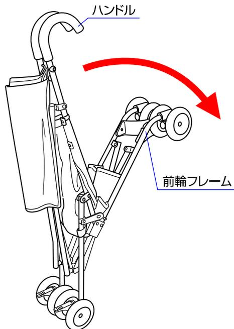
1.開閉ロックを開いてピンから外して下さい。(開き過ぎると破損する恐れがありますのでご注意ください。)
