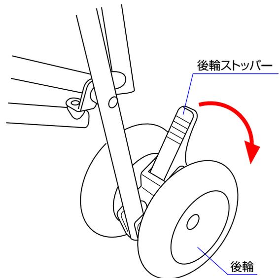
◇両側の後輪ストッパーを下げると後輪がロックされます。解除する時は後輪ストッパーを上げて下さい。※ベビーカーにお子様を乗り降りさせる際には、必ず両側の後輪ストッパーをロックして下さい。
