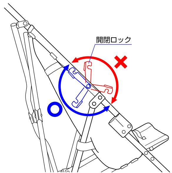
◇ベビーカーを折畳んだ後に自立させたい時は、両側の後輪ストッパーを下げるから、自立スタンドを出して下さい。※ベビーカーを開いて使用する時は必ず自立スタンドを収納して下さい。
