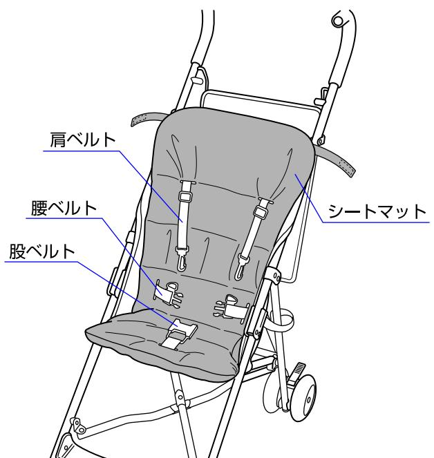
1.シートマットの各ベルト穴から肩ベルト、腰ベルト、股ベルトを出して下さい。
