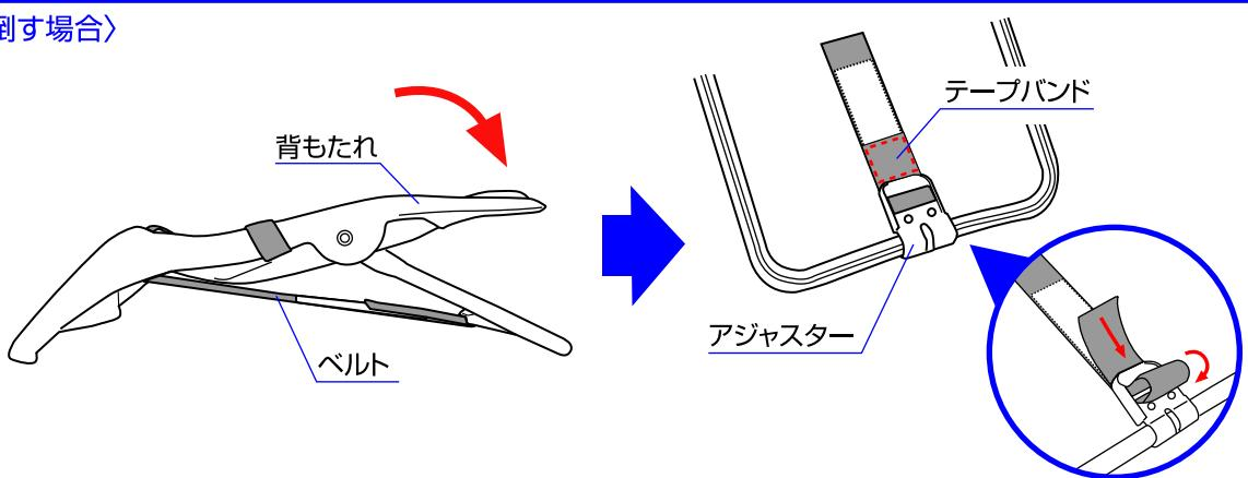
◇アジャスター部分でベルトの長さを調節してテープバンドで固定して下さい。
