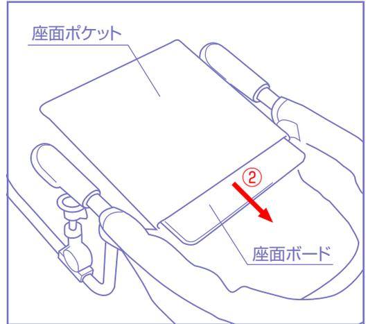
1. ①本体底面の座面ポケットを開いて、②座面ボードを取り出して下さい。③背もたれクッションから肩ベルトを抜き取り、背面と底面の3カ所のテープバンドから取り外して下さい。
