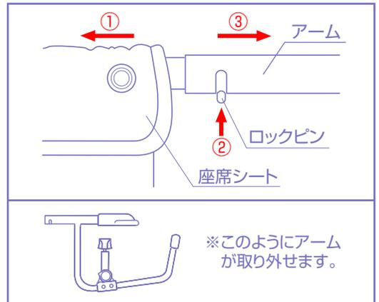
2. 座席シート両側のスナップボタンを外し、①シートを矢印の方向へ引き寄せるとロックピンが出てきます。②アームのロックピンを押しながら、③矢印の方向へアームを引き抜いて下さい。
