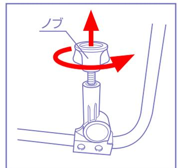
3. ロックバーを起し、ノブを矢印方向に回して締め込み、ロックバーをテーブルにしっかり固定して下さい。
