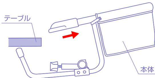
1. ノブを取付時と反対方向に回して緩めて下さい。
