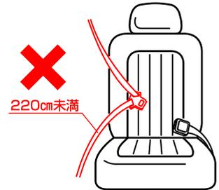
④3点式のシートベルトで肩ベルト側が車のドアに付いているもの
